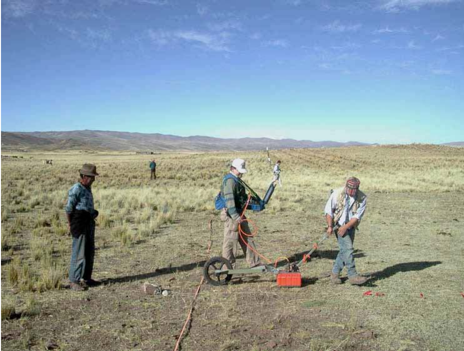
Figura 1: Ejecutando prospección de suelo con el metro GPR prestado por el DINAAR
